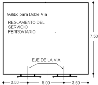
Figura 2. Gálibo para doble vía
