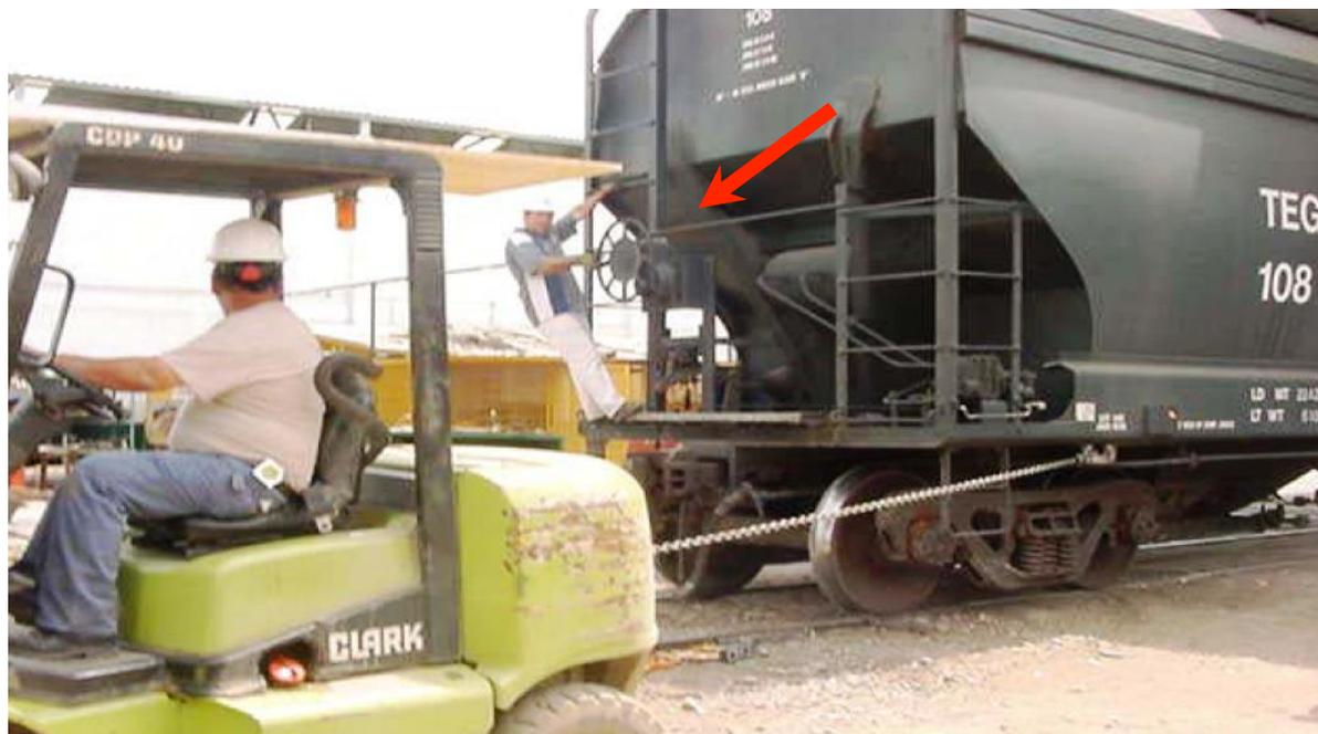
Jalar los carros con un empleado frenando el carro para evitar deslizamientos
