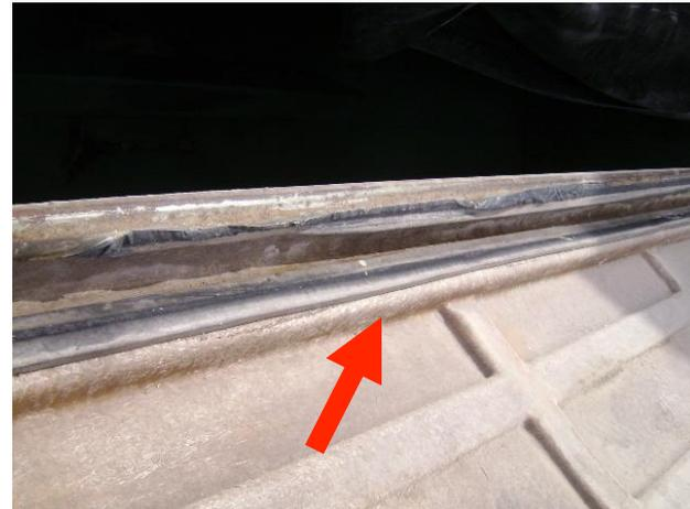
Los plásticos con pegamento, se adhieren a los empaques de las tapas, el cual al retirarlo, dañan dichos empaques de las tapas de Escotilla.
